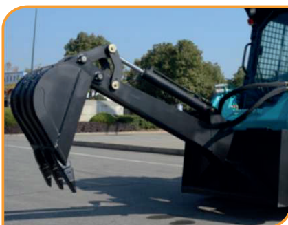
Braț de excavare
