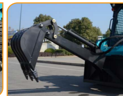
Braț de excavare
